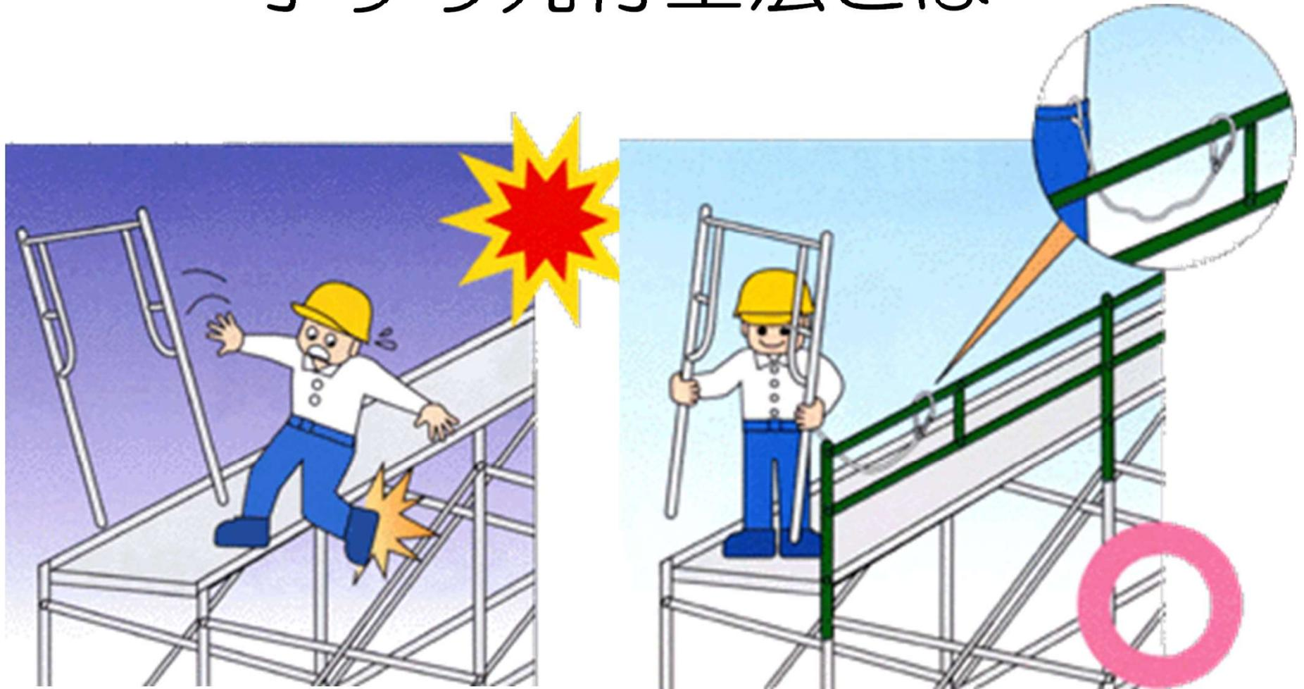
常時先行手すりのある状態で足場の組立、解体及び作業ができる工法
