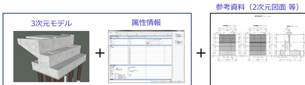
図 2-7 構造物モデルの例
