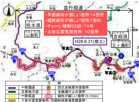
図3 国道218号の現道状況と被災状況
