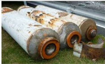
ロッキングピア破損
