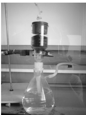
第1図 フィルターホルダーを用いたオゾン試験装置 上部からオゾンを通気させ、下部のベース部分から排気する。
