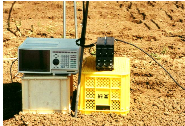
写真4 実験に用いた動ひずみ計とレコーダ
