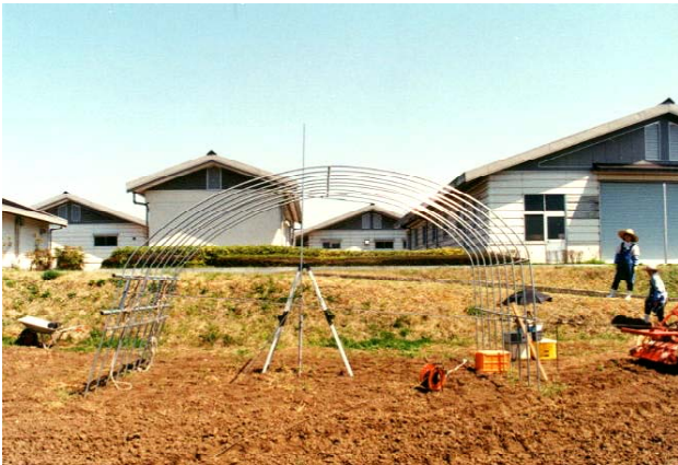
写真3 ハウスの牽引実験状況
