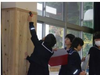
断熱材の効果を調べるため、断熱材入りの教室と断熱材なしの教室の壁や窓の温度を測定し、色分けして比較する実験を行いました。左の写真のように放射温度計で測定した温度を記録して、サーモグラフィーとして図面に色分けして効果を確認しました。「夏は外気を入れずに、朝の冷気を閉じ込める。」「冬は、暖かい空気を外に逃がさない」と学習できました。
