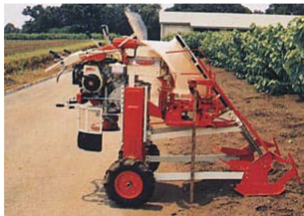
写真1 バインダー型桑収穫機
