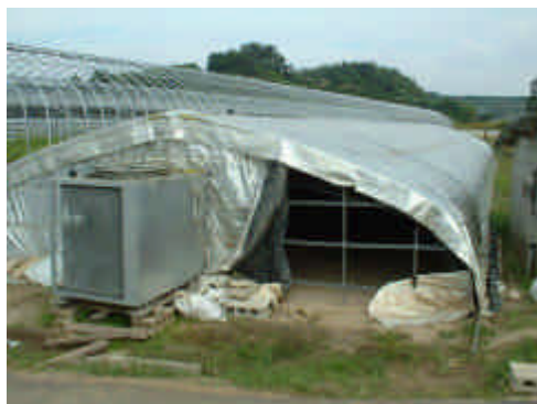
図1 現地で利用されている簡易夜冷装置
