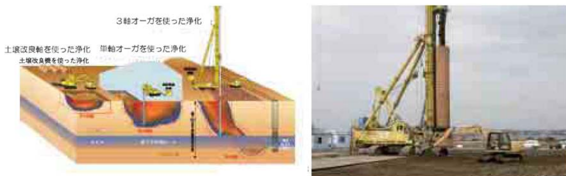
図 8-8 鉄粉法の概念図
