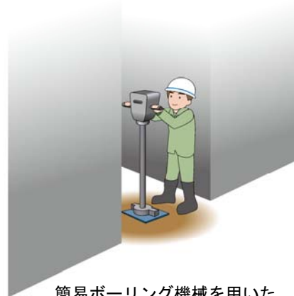
簡易ボーリング機械を用いた 観測井設置状況
