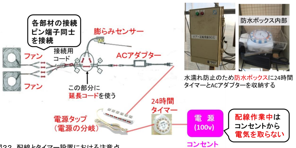
図22 配線とタイマー設置における注意点 (図:「TS ツインエアファン」説明書より)
