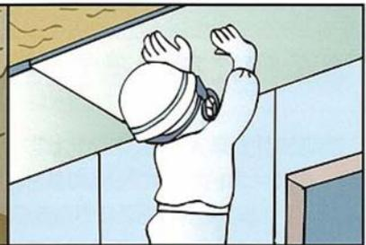
吹付けアスベスト等の層を残したまま、板状材料等で覆うことで、粉じんの飛散や損傷防止等を図る工法。
