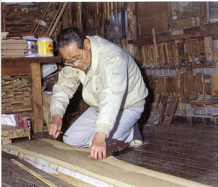
一枚の板から家具の部品を切り出す作業「木取り」
