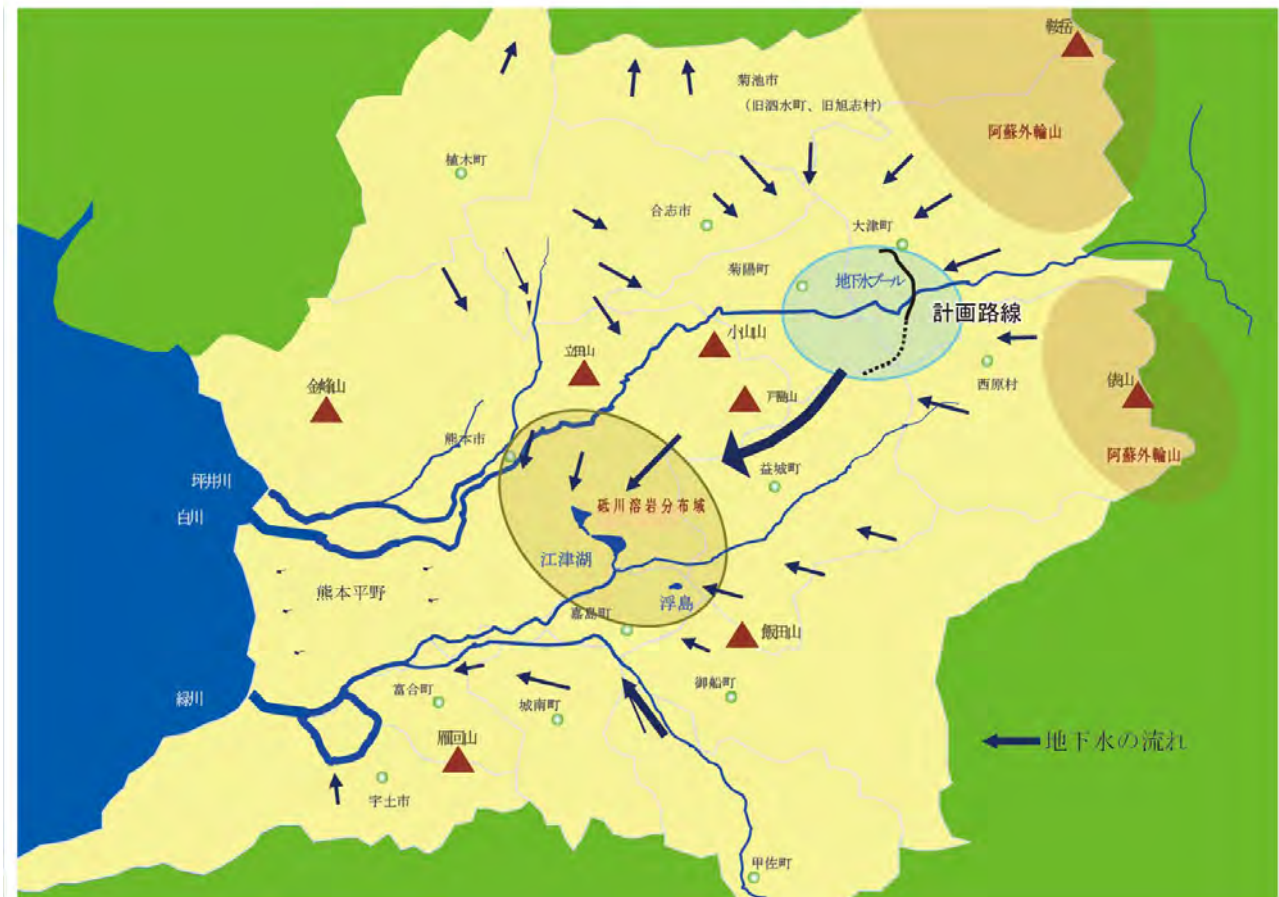
図 3.1.2-3 熊本地域における地下水流動状況図
