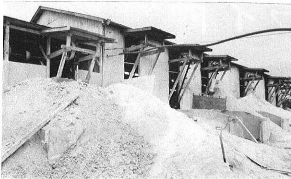
上・原砂は分級機で5段階に分けて、コンベアーで外に運びだされていく。
