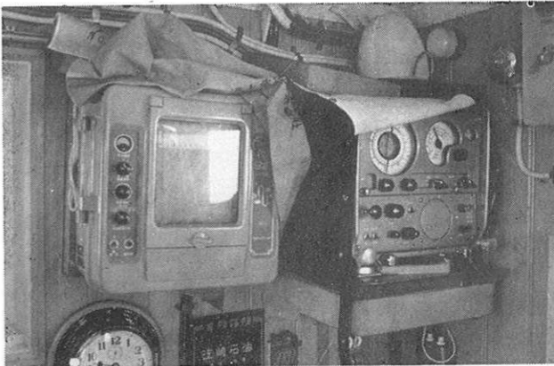
上・ゆきといた機械設備 (左)が音響測深機 (右)が方向探知機
