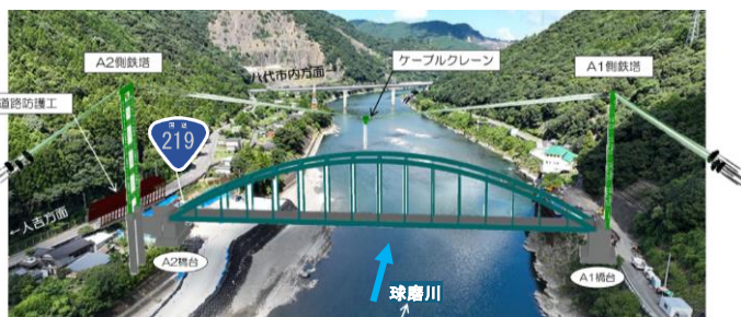
深水橋上部工架設作業イメージ
