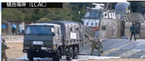
港湾設備のない砂浜から応急救援活動及びインフラの応急復旧に必要な人員・車両を揚陸可能
