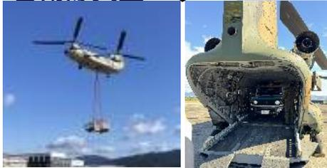
関係機関の応急救援活動に必要な各種車両の機外・機内搭載による空輸が可能
