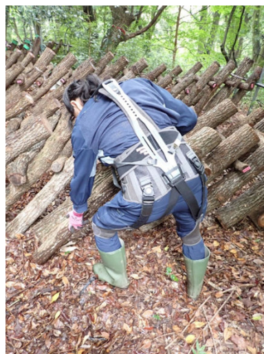
写真 - 4 無動力型アシストスーツ (ユーピーアール製サポートジャケット)
