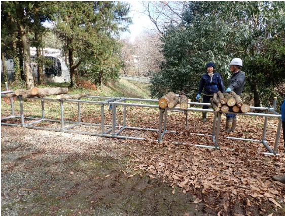
写真 - 2 単管パイプを用いた作業台
