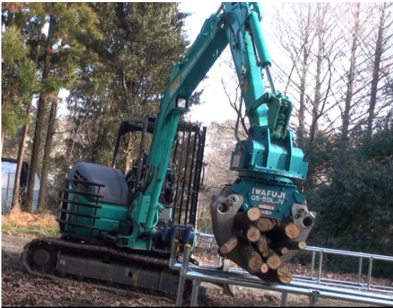
写真 - 6 グラップルで原木をまとめ掴みする様子（左）と樹皮が剥がれた原木（右）
