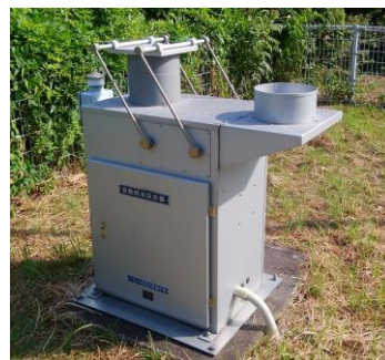
降水時開放型捕集装置（一週間毎） 〔宇土市保健環境科学研究所〕
