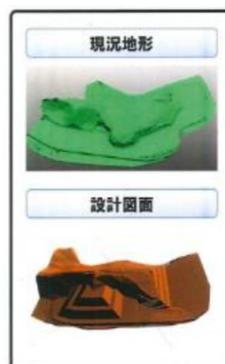
3次元測量データ(現況地形)と設計図面との差分から、施工量(切り土、盛り土量)を自動算出。
