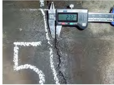
写真 2.1-13 樋管のクラック発生状況
