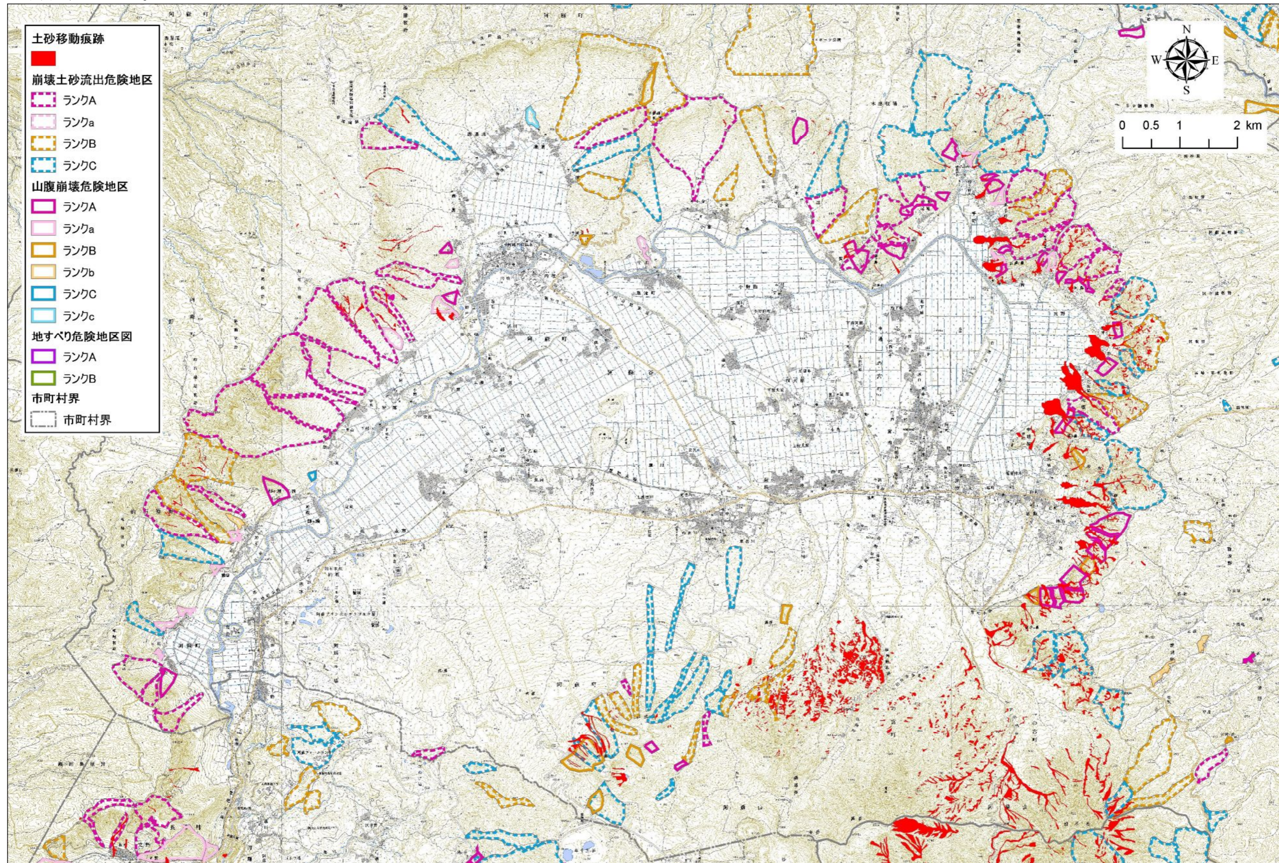
図 3.10 山地災害危険地区(山腹崩壊危険地区、崩壊土砂危険地区、地すべり危険地区)及び土砂移動痕跡の分布(阿蘇山北部)
