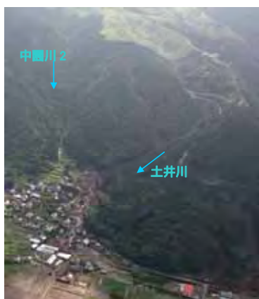
写真 5.1 カルデラ壁急斜面を源頭部とする土石流の流下事例(土井川、中園川2)(写真 3.1 再掲)
