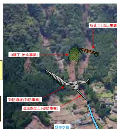
図 5.2 土石流危険溪流鬼塚川(高城A)における治山事業、砂防事業による対策工配置案イメージ
