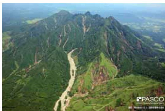
写真 5.5 根子岳の急斜面の崩壊及び土石流の事例(古恵川)(写真 3.5 再掲)
