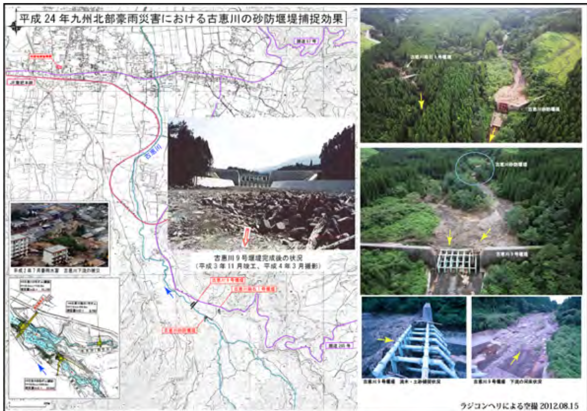
図 3.4 古恵川における既設砂防堰堤の施設効果
