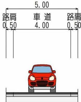
▲タイプ④【歩道なし（1車線）】 改修前
