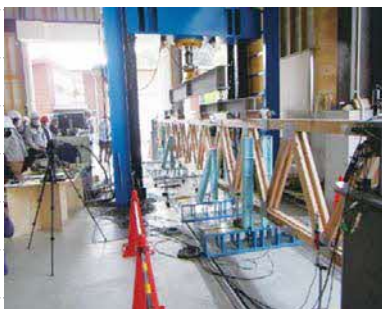
熊本空港木造トラス梁強度試験
