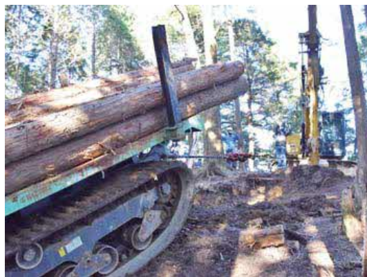
フォワーダをけん引するテザー (県有林下梶原団地：五木村)
