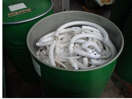
写真 2.4.4 破損した蛍光管の保管容器の例 (通常蓋をしておく)
