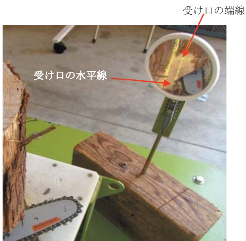
写真-19 受け口の切り合わせ確認状況
