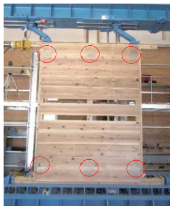
写真2 MPC 設置状況
