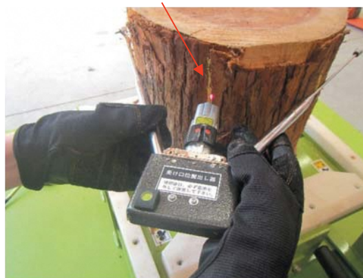
写真-4 伐倒方向を幹に反映させる
