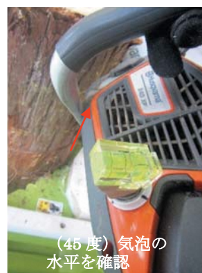
写真-16 チェーンソーの45度を意識して操作
