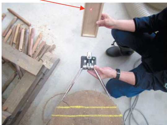
写真-3 伐倒方向の確認 (実際はもっと先のほうを示す)
