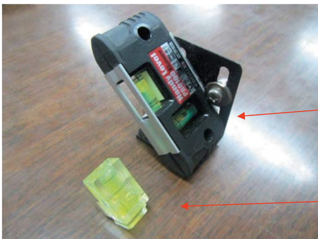
写真-12 チェーンソーの水平（45度）を意識する水準器（あらかじめ45度に固定）
