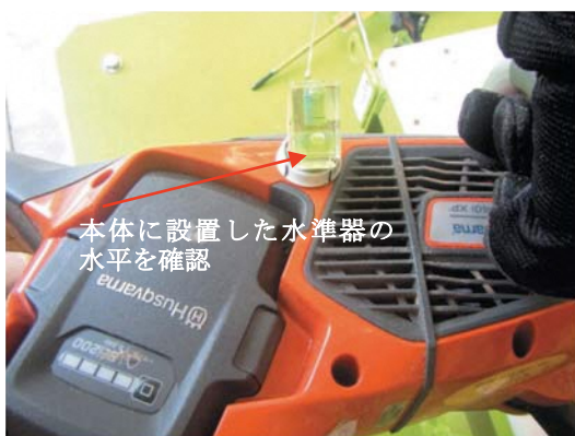
写真-15 チェーンソーの水平を意識して操作
