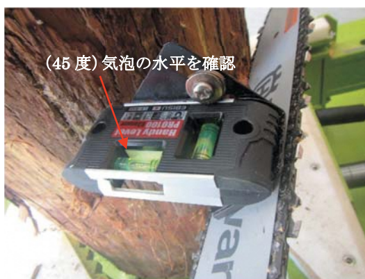
写真-14 チェーンソーのバーの45度を意識
