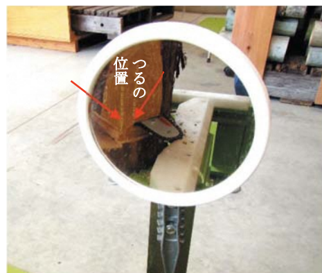
写真-20 追い口の切り止め確認状況
