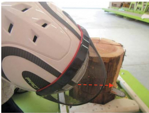
写真-17 追い口裏側位置の目視確認状況
