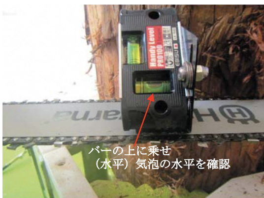
写真-13 チェーンソーのバーの水平を意識
