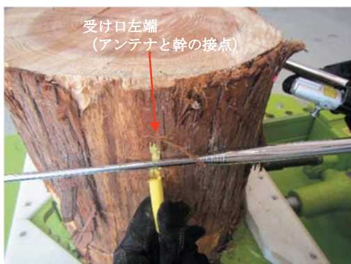
写真-5 アンテナと幹の接点に印を付ける
