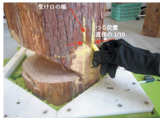
写真-11 つるの位置に印を付ける（直径の 1/10）
