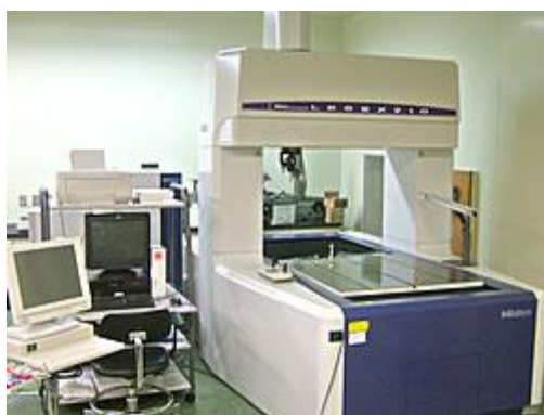
製品等を立体的に計測する三次元測定機
