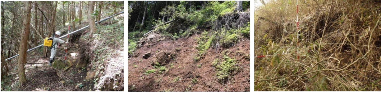
写真 1.2 やせ尾根の様子（やせ尾根両側急傾斜地に発達した谷落ち亀裂）
