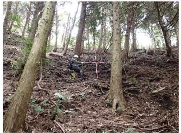
写真 9.2 亀裂周辺の状況（左：亀裂の状況、右：下部斜面の微地形・表層の緩み）
