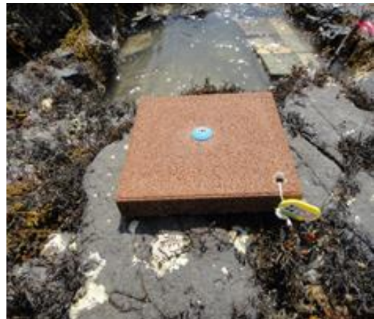
図3 海岸の岩に固定した基板
