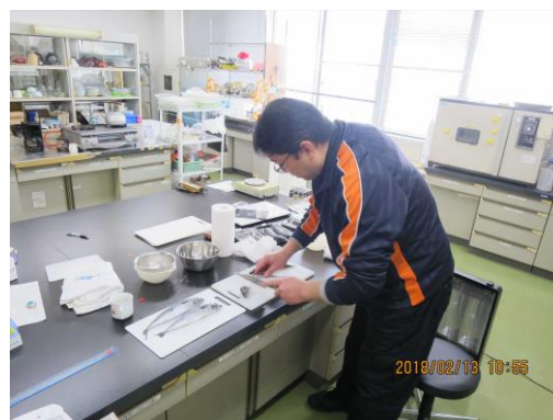
図3 オープンラボでの比重法による測定状況
