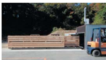
図-1 台車に載せた6m 供試材
