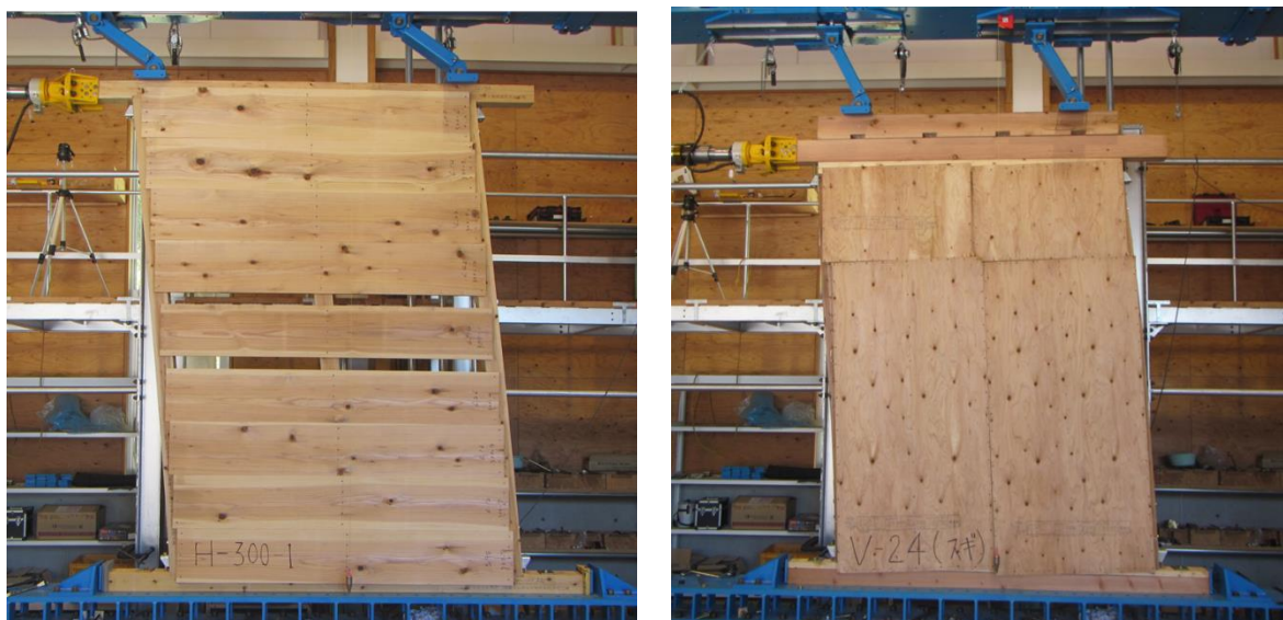
写真－1 面内せん断試験の様子（左側：床構面、右側：枠組壁工法用耐力壁）
