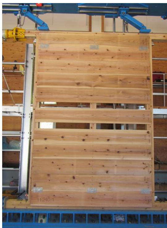
写真－５ MPC 設置状況
