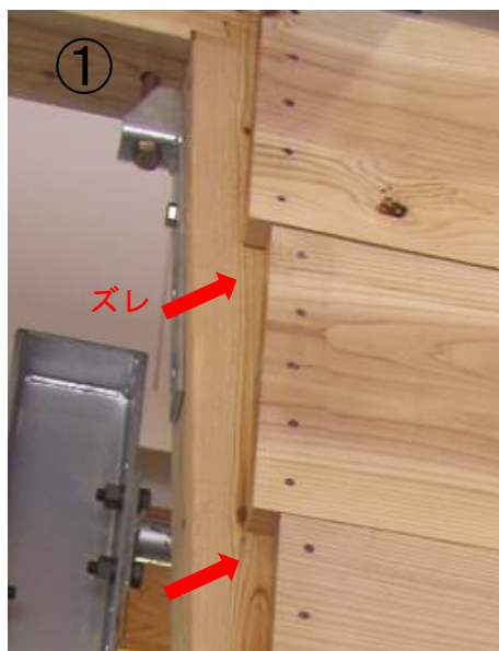
写真-3 試験終了時の床構面の状況（変形時の挙動）
