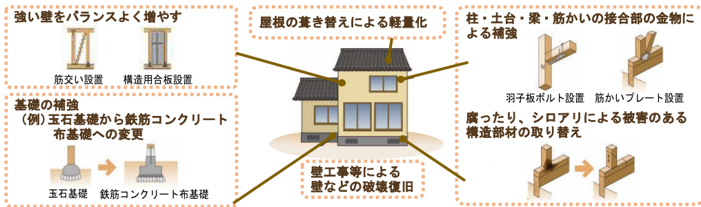
図 3-4 耐震改修のイメージ
