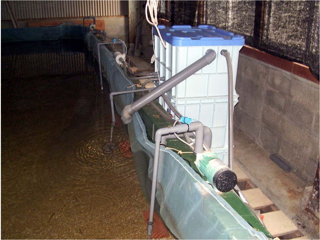
飼育水槽、マイクロバブルによる酸素供給装置
