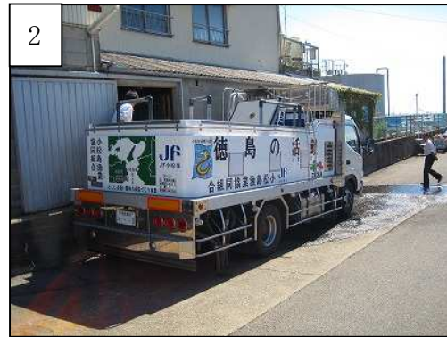
図1：丸で囲んでいる部分が「そうめん流し」と呼ばれる装置。ハモを海水と一緒にパイプを通して水槽に運ぶ。ハモの噛み合いやすれを防ぐ効果がある。
