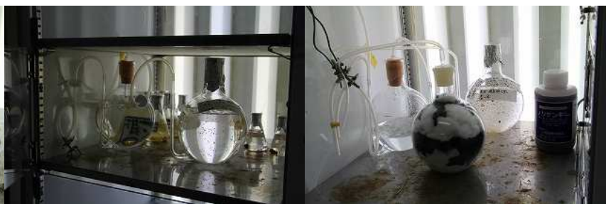
図4 通気拡大培養 (左：蒸留水のみ、右：活性炭の追加)
