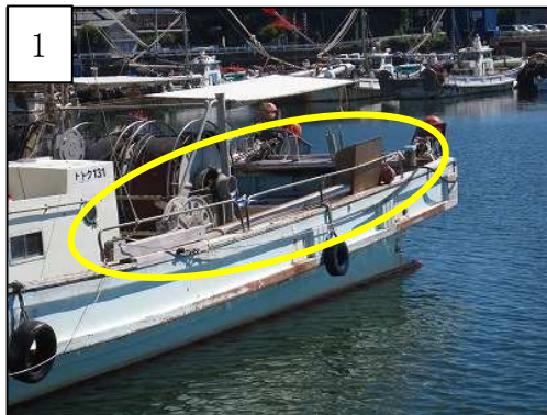
図1：丸で囲んでいる部分が「そうめん流し」と呼ばれる装置。ハモを海水と一緒にパイプを通して水槽に運ぶ。ハモの噛み合いやすれを防ぐ効果がある。
