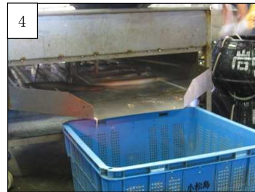
図3,4：ハモの選別状況。小型のハモは下の台に落下し、再放流される。
