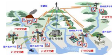
戸別受信機の設置
