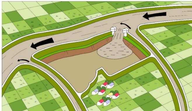
用地買収(掘り込み)方式のイメージ
