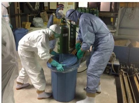
ポリバケツ等への炭酸ガスの注入
