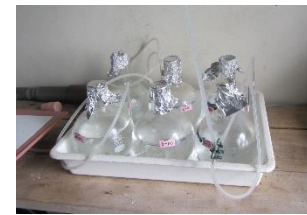
写真1 PL材の保管状況(室内で通気・遮光)
