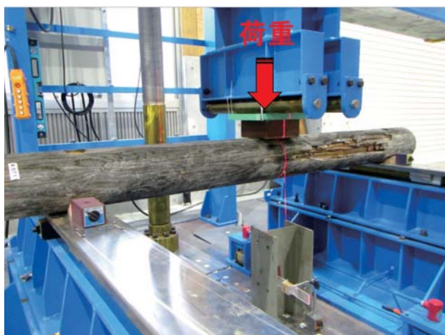
写真-10 強度試験の実施状況（破壊まで荷重）
