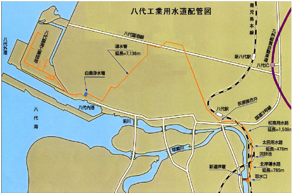
図表 15 配管図（八代工業用水道）
