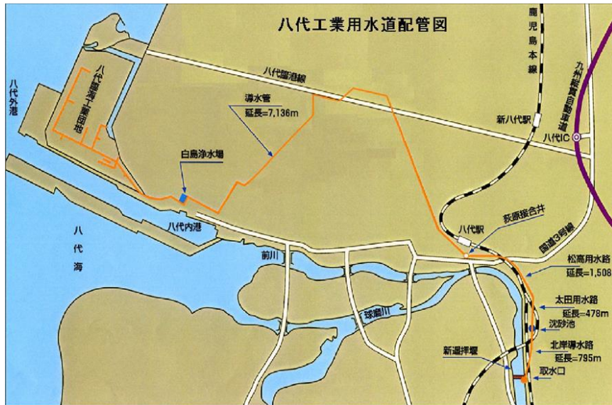
図表 15 配管図 (八代工業用水道)
