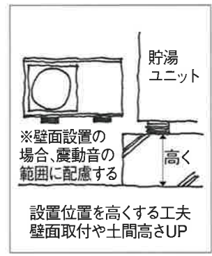
エアコン・給湯器の室外機
