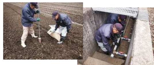
精密水田での縦孔による排水試験 (縦孔への籾殻の充填作業、暗渠排水量調査)
