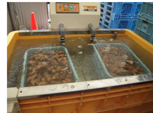
写真2: 温湯消毒機での処理の状況
